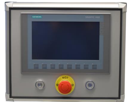
SIMATIC-Steuerung mit farbigem Touchdisplay
