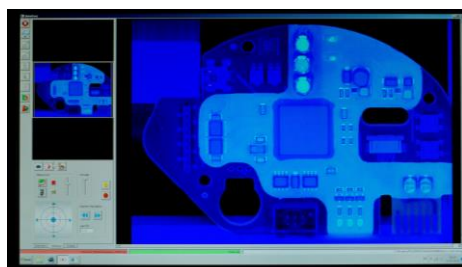
Optimale AOI-Prüfung der scharfen Lackgrenzen
