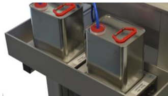
Lackbehälter auf Waage
